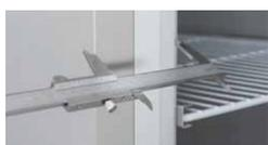
▲ Espessura do Isolamento: 70 mm
