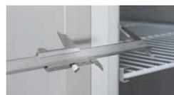
▲ Espessura do Isolamento: 70 mm
