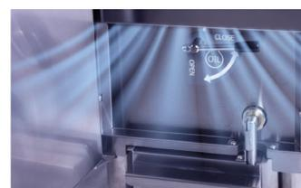
▲ Isolamento do depósito e sistema de extração de ar quente para uma melhor eficiência térmica e redução do sobreaquecimento do chassis.
